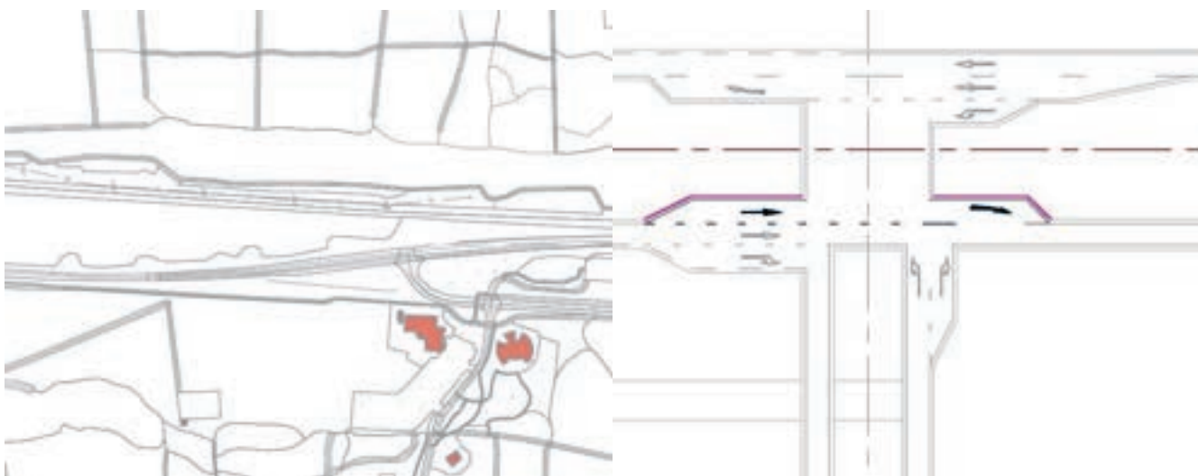
Figuur 3-15 Alternatief 1 (traject 11) VRI-kruispunt Grotestraat hm 32.36, rijstrookschema met indicatieve weergave van een extra opstelstrook in de richting van Nijverdalen
