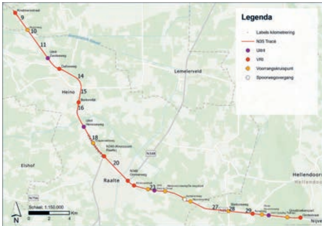
Figuur 2-3 Kruispunten langs het bestaande tracé van de N35 (hectometrerings is langs tracé aangeduid). In de autonome situatie wordt het VRI-kruispunt N348 Deventerweg-N35 gewijzigd in een ongelijkvloerse aansluiting (knooppunt Raalte)
