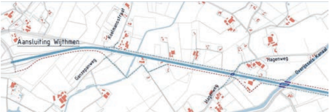
Figuur 3-22 Alternatief 2 (traject 1 en 2) vilstiftschets variantpakket 1: N35 2x1 stroomweg 100 km/uur met afsluiten Koelmansstraat, ongelijkvloerse kruising Hagenweg en (handhaven) onderdoorgang Overijssels kanaal voor langzaam verkeer (rood=nieuwe weg, blauw= aan te passen/te verleggen bestaande weg)
