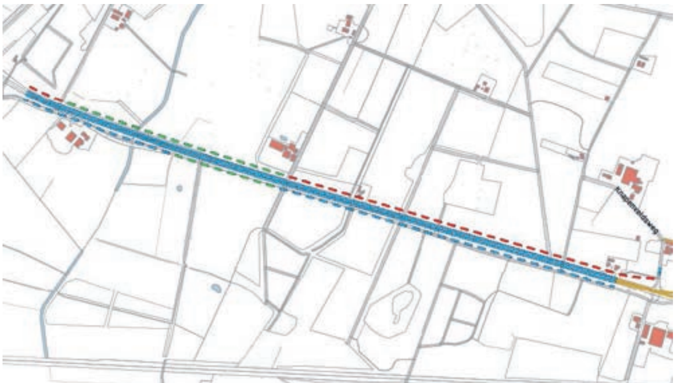
Figuur 3-26 Alternatief 2 (traject 7) viltstiftschets parallelstructuur Heino-Raalte met opheffen bajonetkruispunt (rood=nieuwe weg, blauw= aan te passen/te verleggen bestaande weg, groen= aan te passen weg bij bajonet)
